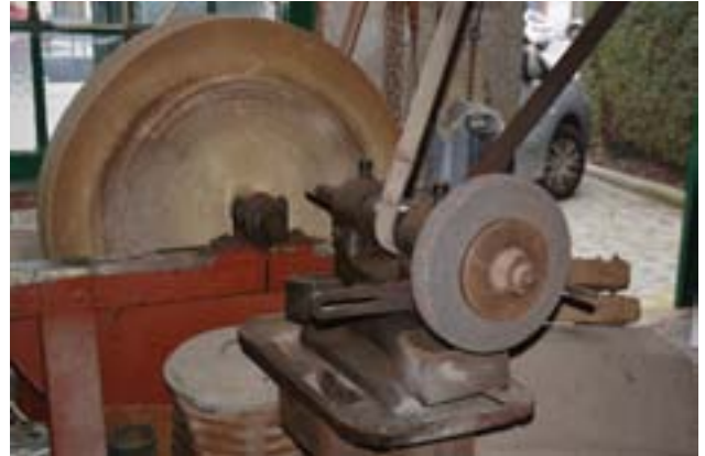
De kleine en de grote slijpsteen. Let op de riemen die naar de transmissieas gaan.
